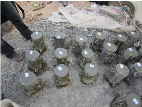
Abbildung 15 Prüfzylinder aus Bohrpfahlbeton
