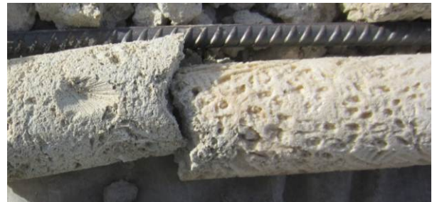
Abbildung 2 Bohrkern aus dem Korallenstein
