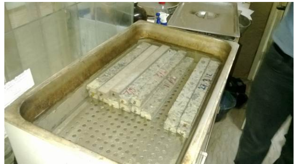
Abbildung 11 Sulfattest nach ASTM C1012, Prüfkörper
