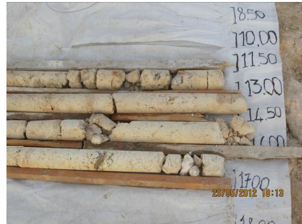
Abbildung 20 Ergebnisse einer Kernbohrung nach Injektion
