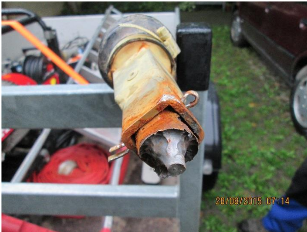
Abbildung 7-1 - Korrosion an Edelstahlspindel und Schrauben
