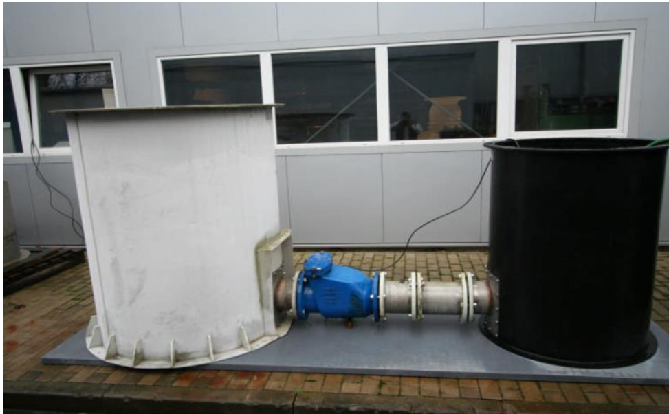
Abbildung 6-4 - Versuchsanordnung Eignungstest Rückschlagklappen
